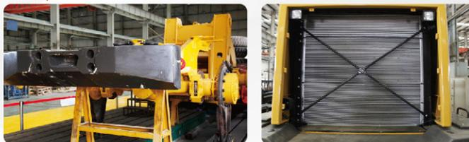
单排横向铝散热系统，散热器截面积**加大23%**，散热效果好，易于维护清洗，更适应各种恶劣工况。
